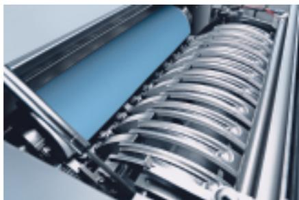
Los cuerpos de impresión, la marcha del pliego y el dispositivo de inversión están diseñados para ofrecer una precisión máxima y para conducir el pliego con suavidad.
