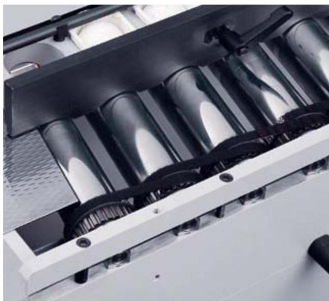
Accionamiento de los rodillos enderezadores de cromado duro de la mesa de rodillos oblicuos mediante correas dentadas para obtener una marcha sincronizada.
