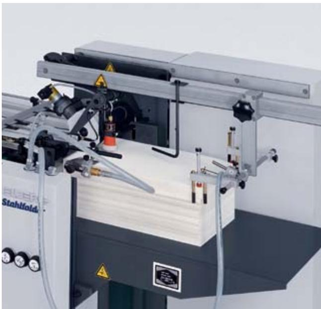
Dispositivo de separación de pliegos con sopladores Airwing para separar con fiabilidad los pliegos en el marcador de pila plana Fi 52.
